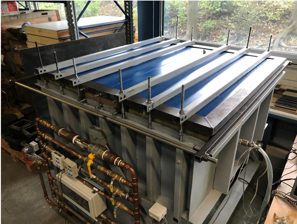
Abbildung 2: Luftdichtheitsprüfstand mit eingebautem Probekörper
