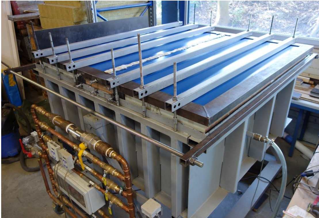
Abbildung 2: Luftdichtheitsprüfstand mit eingebautem Probekörper
